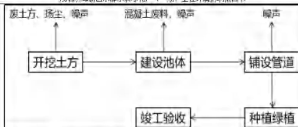
图 3.3-2 项目施工工艺流程图（污水池）
