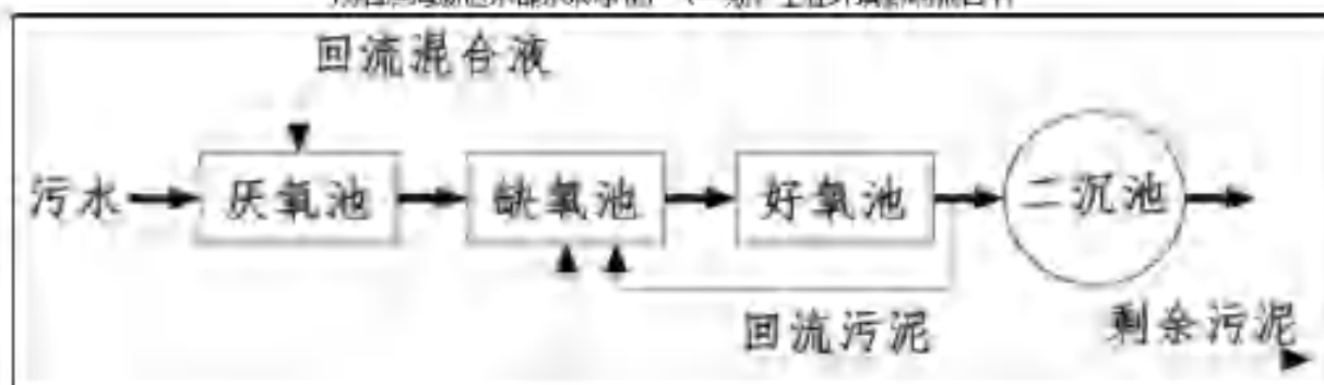
图 3.2-8 UCT 工艺流程简图
